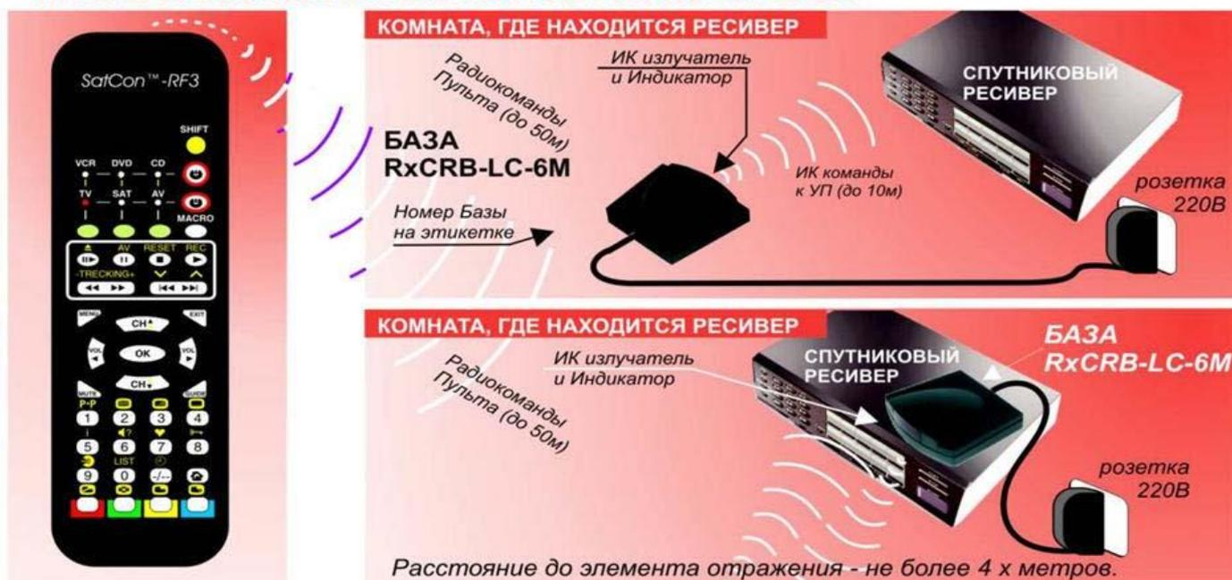
На рис. 1 показан пример управления спутниковым ресивером. При нажатии кнопки на Радиопульте излучается радиокomанда, которая принимается Базой. При правильном приеме База излучает через ИК - излучатель соответствующую ИК команду ресиверу. При этом светящийся Индикатор **\* · · ·** на Базе мигнёт.
